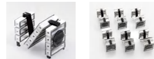
(硬树脂+韧树脂→超材料移动微型机器人)
