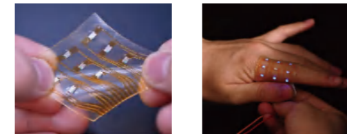
(导电弹性体+弹性基底→柔性电子)
