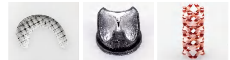
水凝胶+硬树脂增强相→半月板 弹性体+硬树脂→心脏瓣膜 SMP+水凝胶→形状记忆心血管支架
